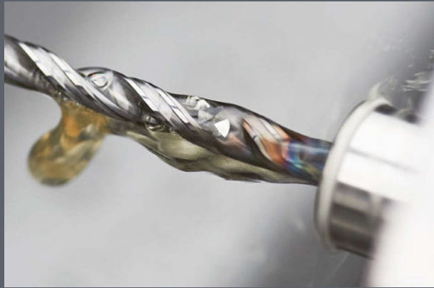
オイルホールドリルによる深穴ドリル加工。分断された切りくずがドリルの溝を通して排出されるため、切りくず絡みの心配がありません。
