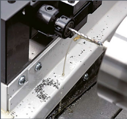
オイルホールドリルによる深穴ドリル加工。分断された切りくずがドリルの溝を通して排出されるため、切りくず絡みの心配がありません。
